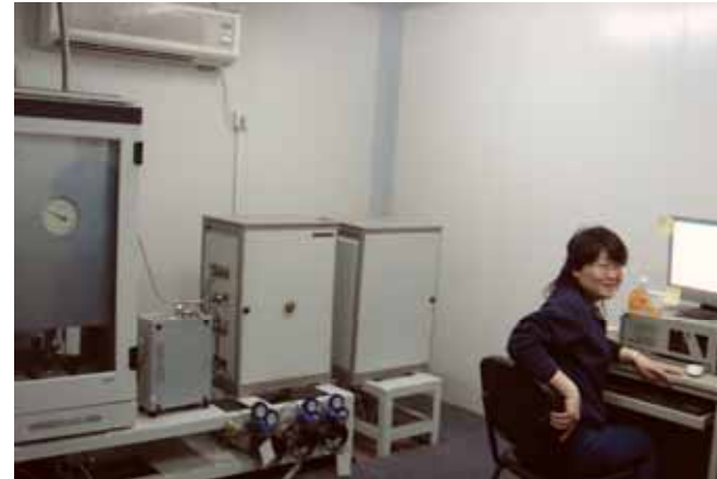
Оборудование газоаналитического комплекса ЭМГ-20-1 в помещении газового анализа
